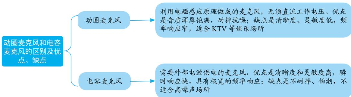
图 1-4 动圈麦克风和电容麦克风的区别及各自的优点、缺点
