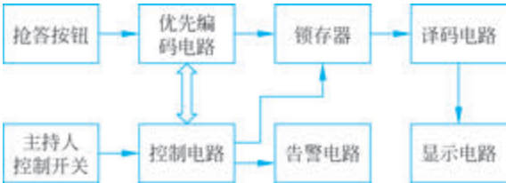
图 3-3-7 智力竞赛抢答器系统框图
