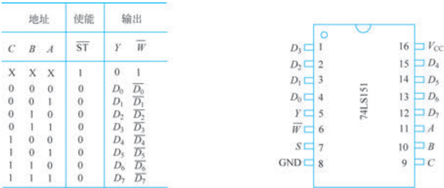
图 3-2-3 74LS151 功能表和引脚图
