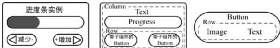
图 3-24 Progress 实例的设计分析图
