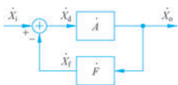
图 5.3.1 负反馈放大电路框图
