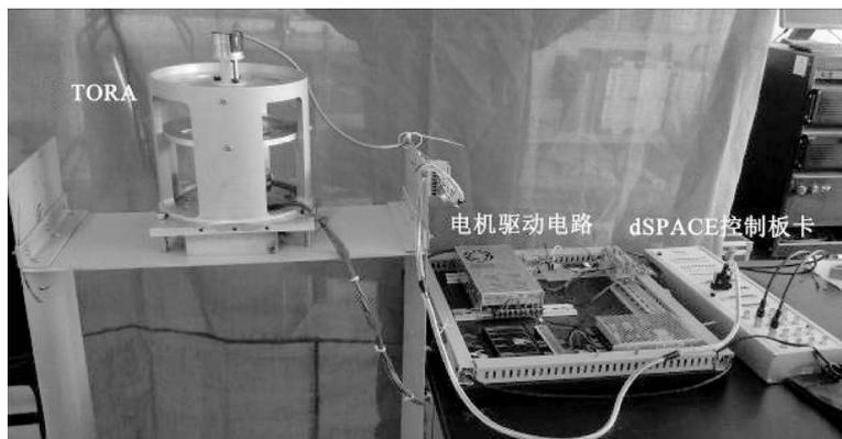
图 5-22 TORA 系统半实物仿真实验平台
