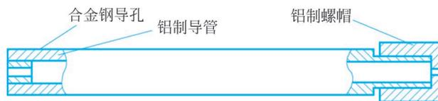
图 5-84 穿线导管原理图
