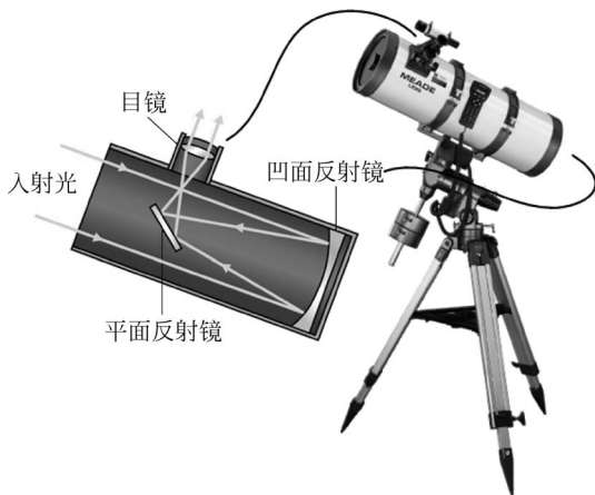
图 5-13 常见的反射式望远镜原理图
