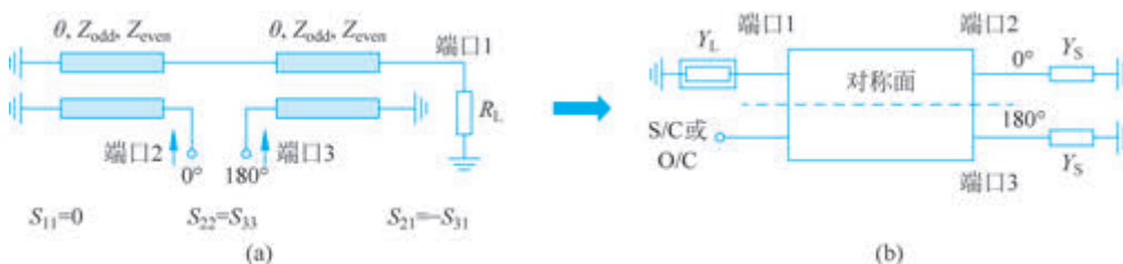
图 3.4.15 分布式耦合器的电路简化图
