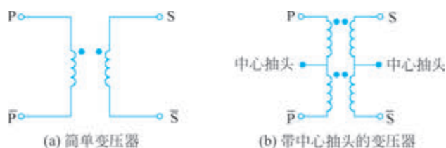
图 3.4.2 变压器的电路符号
