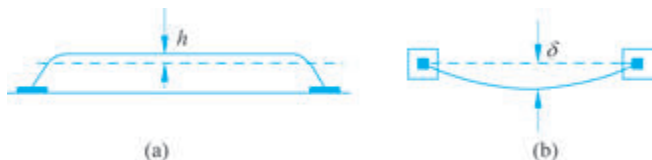
图 3.3.12 引起键合线电感量变化的因素
