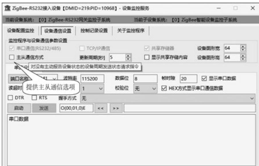
图 5.12 串口设置与主从通信设置
