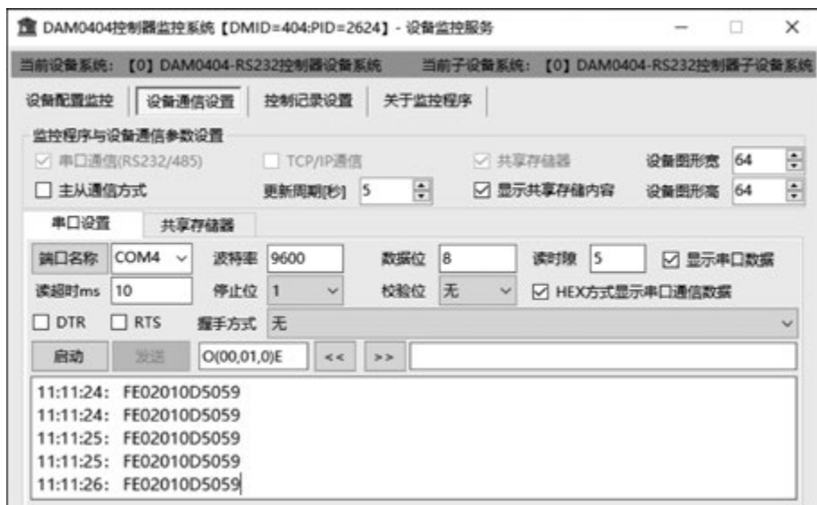
图 5.15 串口通信参数设置和通信数据显示
