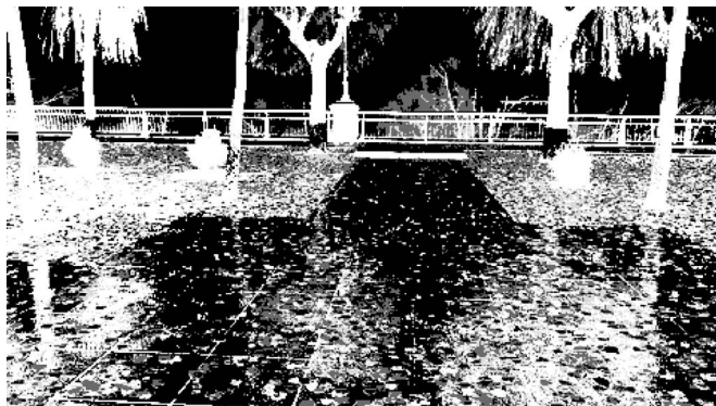
图 5-11 固定阈值类型为 cv2.THRESH_BINARY_INV
