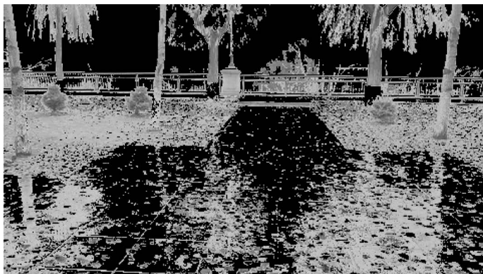
图 5-14 固定阈值类型为 cv2.THRESH_TOZERO_INV
