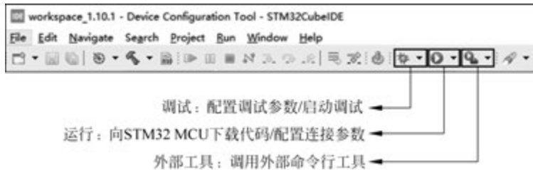
图 3-87 STM32CubeIDE 调试/下载/工具配置说明
