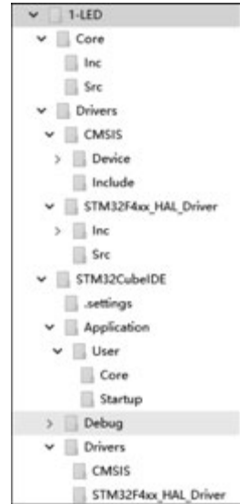
图 3-49 用户程序文件架构
