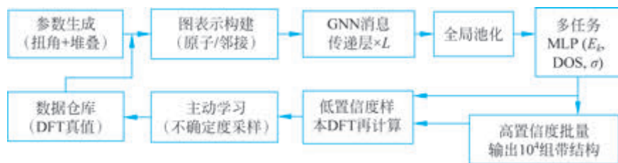
科普图 3-1 基于人工智能算法的原子级平带工程架构图
