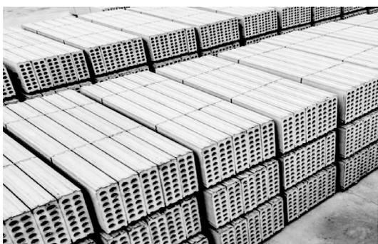
图 1-9 钢筋陶粒混凝土轻质隔墙条板
