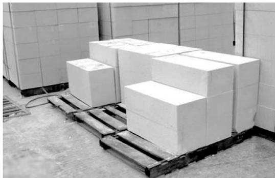
图 1-6 蒸压加气混凝土砌块
