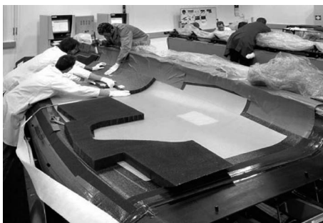
图 1-9 裁剪中的航空复合材料
