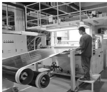
图 1-10 碳纤维 T800 生产线
