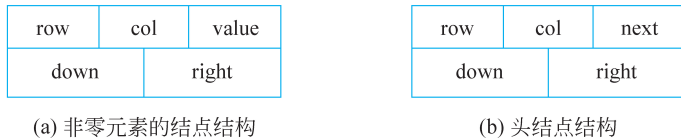
图 5.2 十字链表的结点结构
