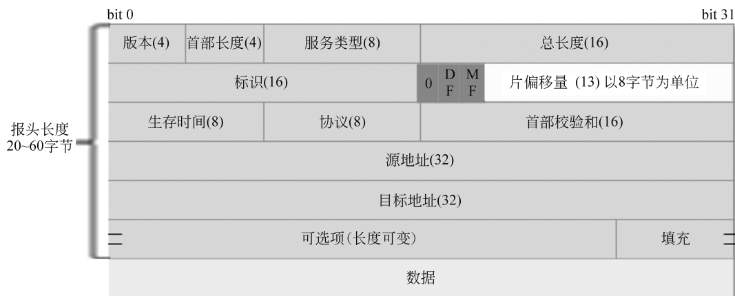
图 5-10 IPv4 协议的 IP 报文格式
