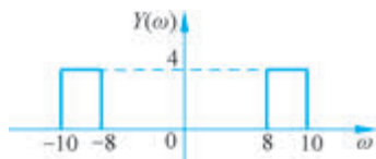
图 3-118 输出信号 y(t) 的频谱图
