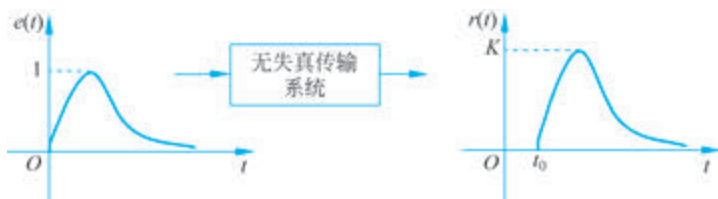
图 3-90 无失真时激励响应关系图
