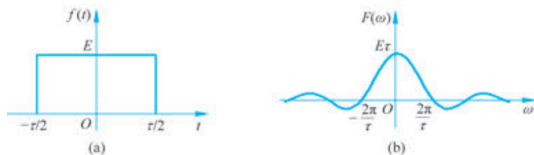
图 3-43 门函数的时域波形和频谱图
