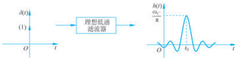
图 3-97 单位冲激信号经过理想低通滤波器
