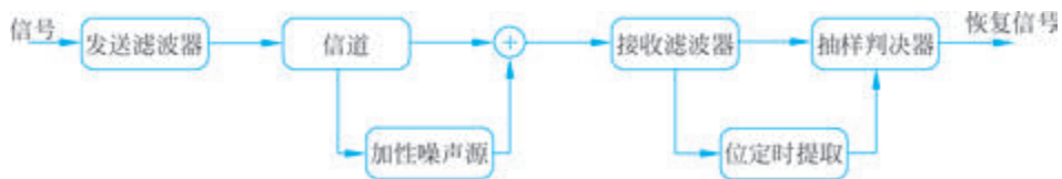
图 3-137 数字基带传输系统的示意图
