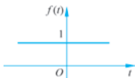
图 3-37 直流信号的时域波形
