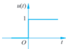
图 3-55 单位阶跃信号的时域波形
