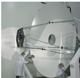
图 1.2.1 星载赫歇尔碳化硅天线
