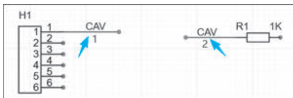
图 5-39 采用网络标签进行电气点连接
