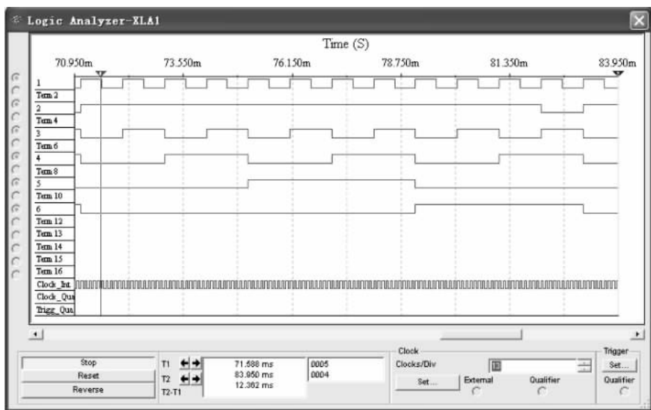
图 5.5.6 74LS161 构成十二进制计数器仿真时序波形
