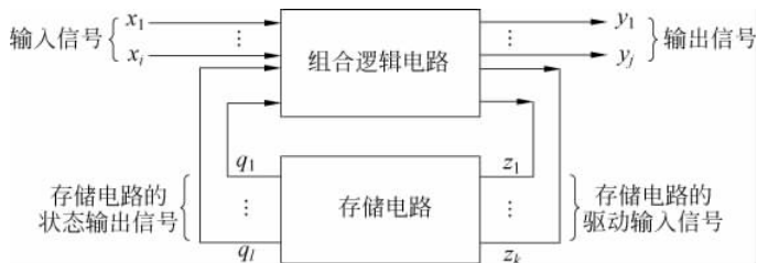
图 5.1.1 时序逻辑电路结构示意图
