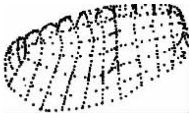
图 3-2 CMM 测量的点云
