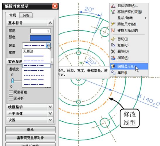
图 3-94 修改圆轮廓线型
