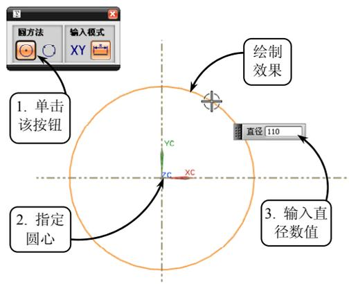
图 3-17 指定圆心和直径绘制圆
