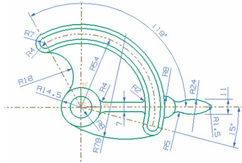
图 3-62 摇臂板零件平面图
