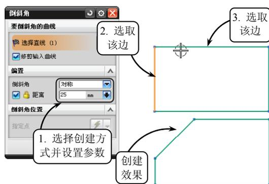
图 3-36 精确法倒斜角
