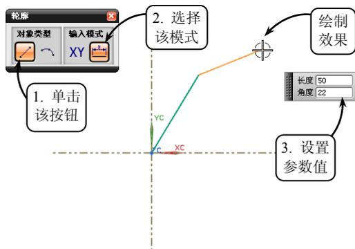
图 3-13 利用【轮廓】工具连续绘制直线
