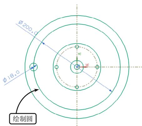
图 3-84 绘制圆轮廓线
