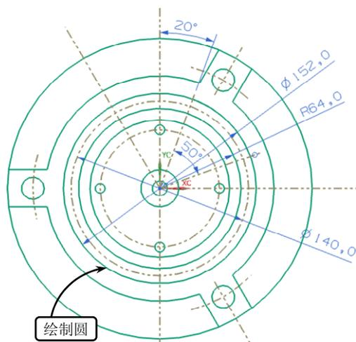
图 3-95 绘制圆轮廓线
