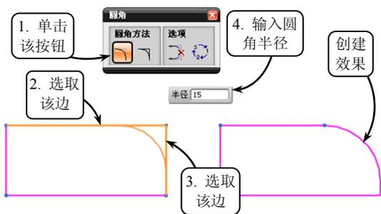
图 3-33 精确法创建圆角
