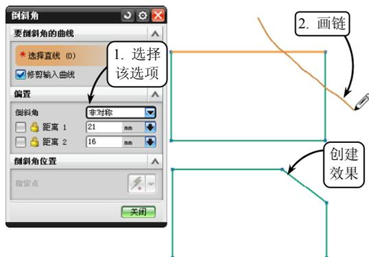
图 3-37 粗略法倒斜角
