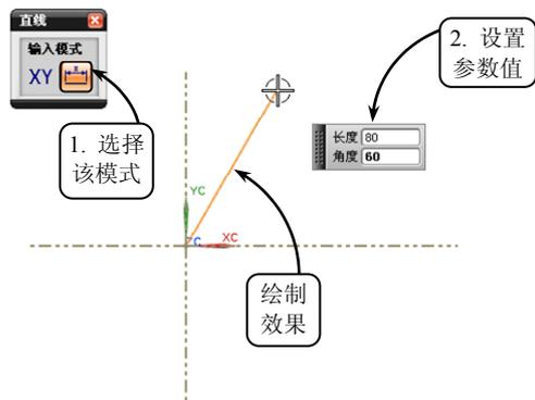
图 3-12 利用【直线】工具绘制直线
