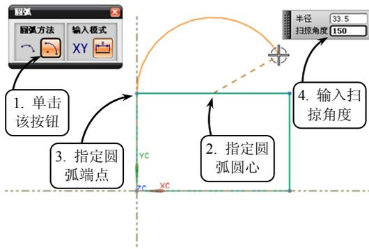
图 3-20 指定中心和端点绘制圆弧
