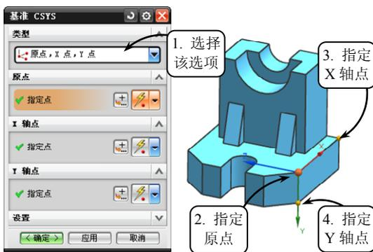
图 3-5 创建基准坐标系
