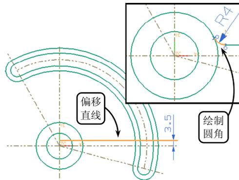
图 3-66 偏移直线并绘制圆角
