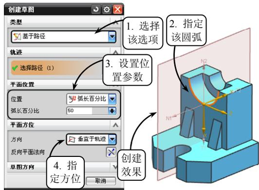
图 3-6 指定路径创建草图平面
