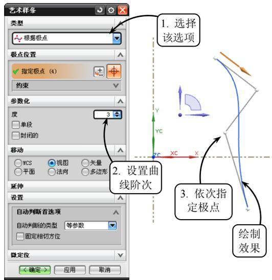
图 3-26 指定极点绘制样条曲线
