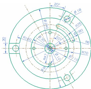
图 3-76 吸盘零件平面图效果
