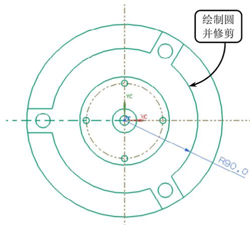
图 3-91 绘制圆轮廓并修剪
