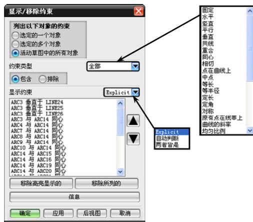
图 3-48 【显示/移除约束】对话框
