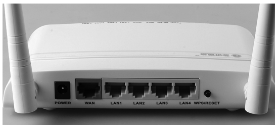
图 5-16 常用的路由器 (配置一个因特网接口(WAN)和多个以太网接口(LAN))
