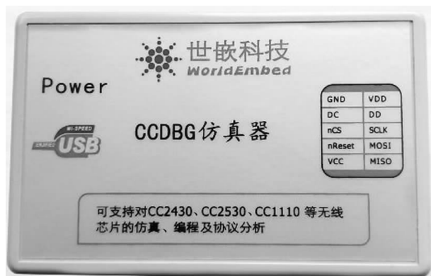
图 3-11 CCDBG 仿真器(上面虽未标明支持 CC2540,但实际完全支持)
