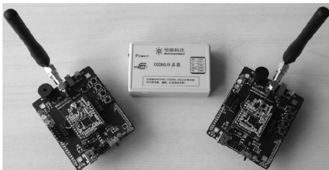
图 3-2 CC2540 蓝牙4.0低功耗最简配置开发板套件(2模块+2底板+1仿真器)
