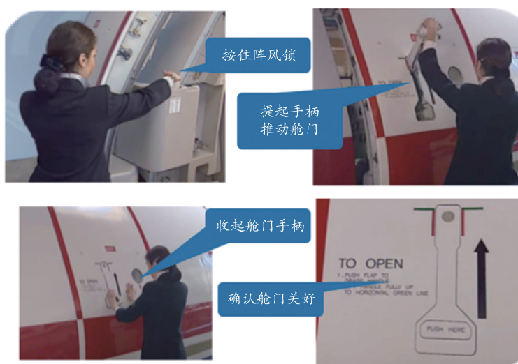
图 1-22 外部关闭舱门操作
