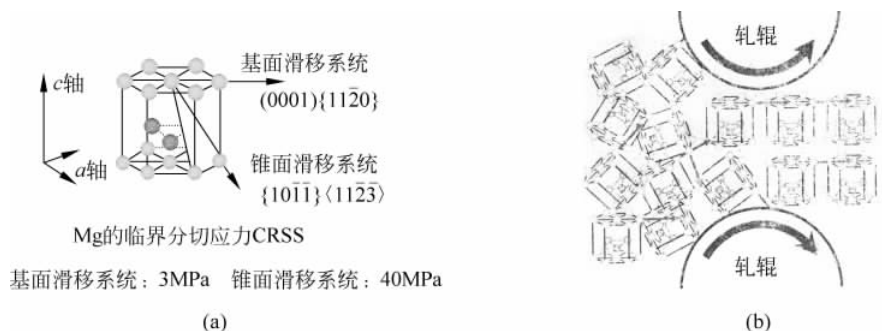
图 3-4 Mg 的室温滑移系统及临界分切应力 (CRSS) (a) 和轧制变形组织的形成机制 (b)
