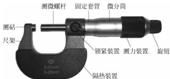
图 1-4 外径千分尺的结构
