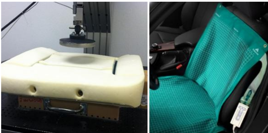
图 1.6 座椅发泡硬度测试(左)及体压分布测试(右)
