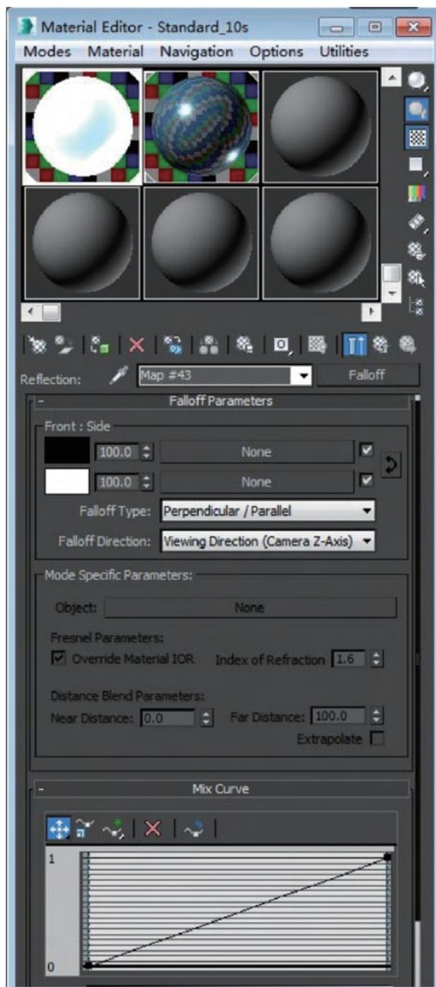
图 5-22 设置 Falloff 贴图参数
