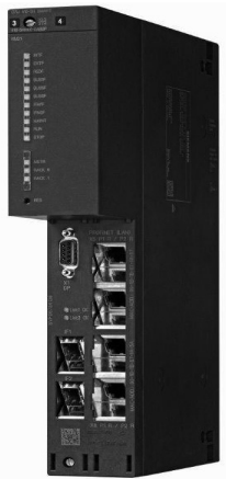
图 5-9 CPU 410-5H 外观及技术特点
