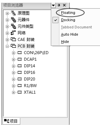
图 2-6 切换窗口显示方式
