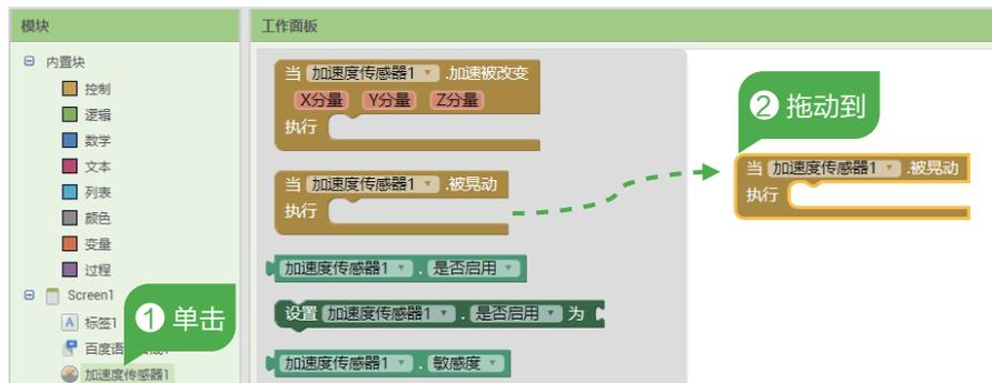
图 2-10 添加加速度传感器被晃动事件
