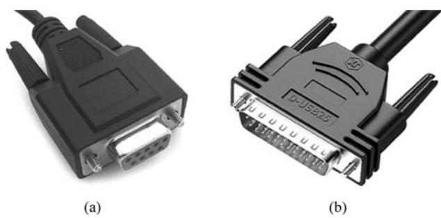
图 3.10 DB9M 串口和 DB25F 并口实物图
