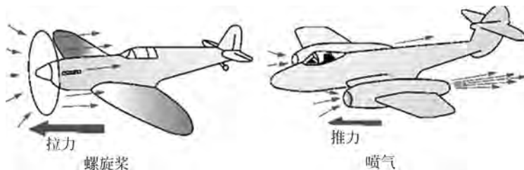
图 1-16 螺旋桨的拉力和喷气推力的产生
