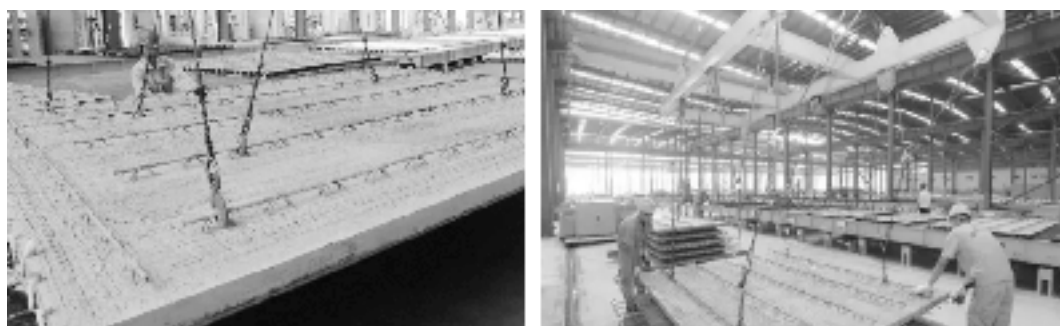
图 1-6 PC 构件模具脱离
