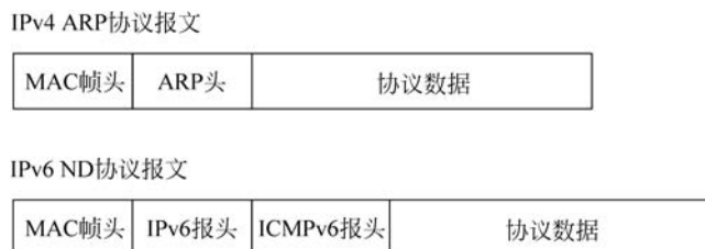
图 3-2 ARP 与 ND 协议报文封装
