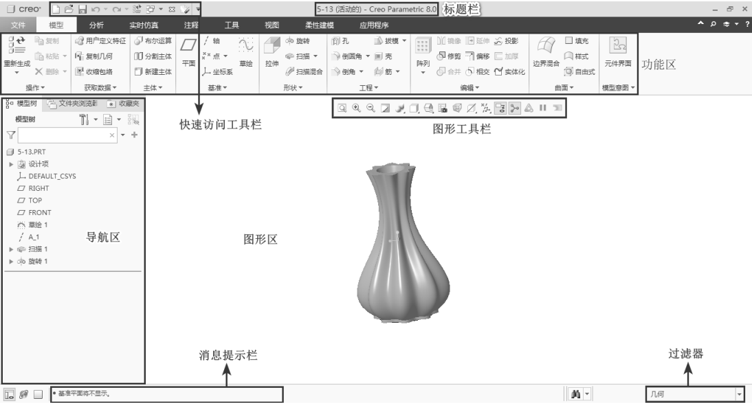
图 1-1 Creo Parametric 8.0 零件工作界面
