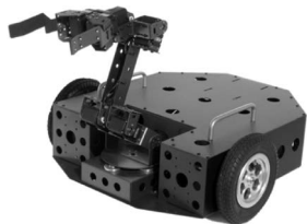
图 3-9 两轮驱动机器人模型
