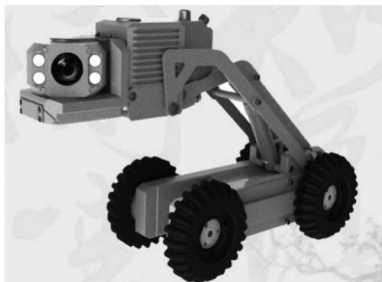
图 3-8 典型的四轮驱动机器人
