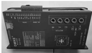
图 3-23 无刷驱动器实物图
