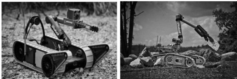
图 3-2 履带式行走机构(irobot)
