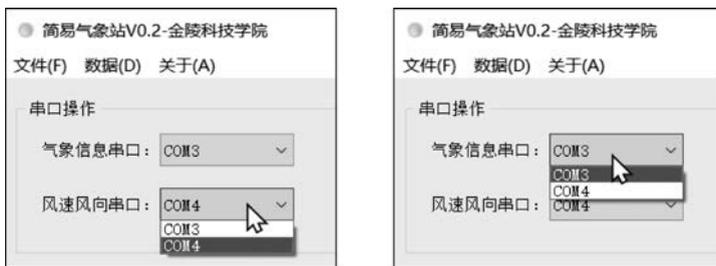
图 5.20 程序运行后自动检测并显示的串口信息
