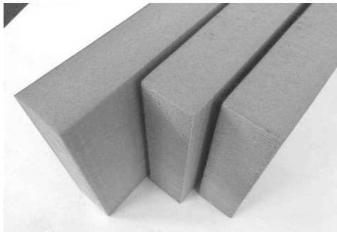
图 1-18 挤塑聚苯乙烯泡沫塑料(XPS)
