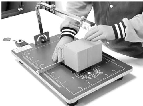
图 1-16 电热切割机粗切割原型
