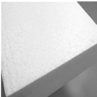
图 1-17 模塑聚苯乙烯泡沫塑料(EPS)
