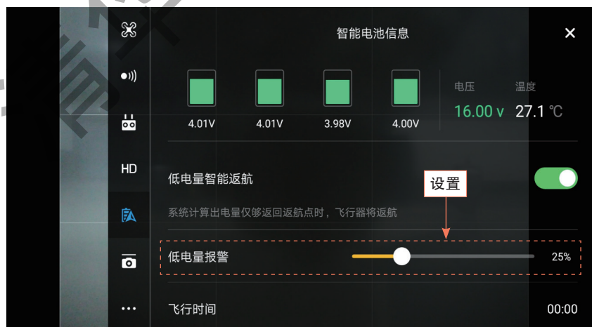
图1-24 手动设置低电量的报警提示
