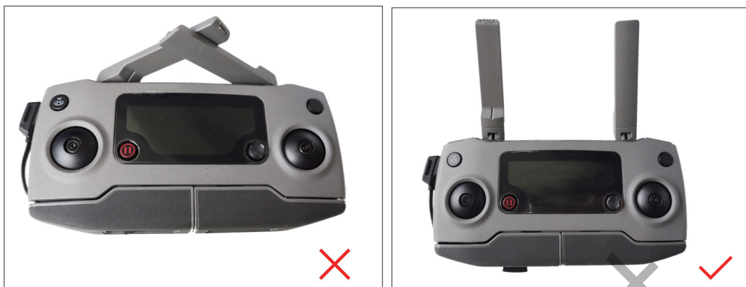
图1-14 遥控器天线的正确方式
