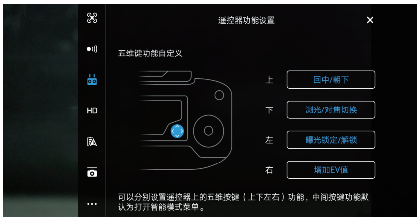
图1-16 自定义设置五维键的功能
