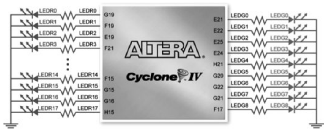
图 3-20 DE2-115 开发板 LED 驱动电路与 FPGA 器件 I/O 引脚的接口信息
