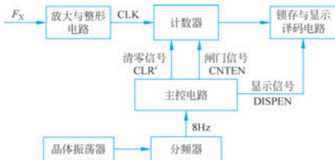
图 3-83 直接法频率计总体设计方案
