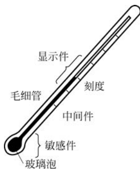
图 2-4-2 水银温度计结构
