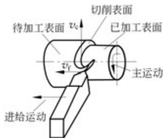
图 2.12 外圆车削的切削运动与加工表面
