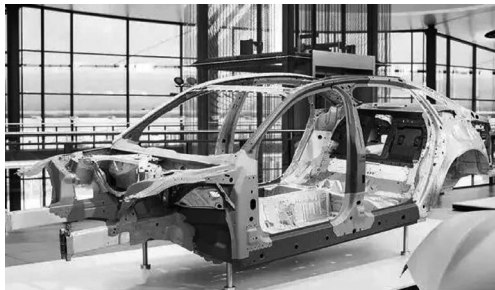
图 1-6 冲压焊接成型的车身
