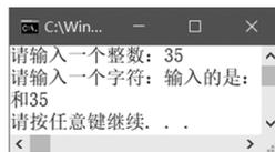
程序一先输入字符,再输入整数,运行结果正常。程序二先输入整数,再输入字符,运行时出现了问题:程序直接跳过字符的输入。其原因是:输入 35↵后,35 被变量 a 接收,但回车符仍然留在输入缓冲区,接下来执行语句
