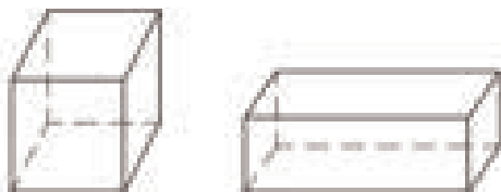
图1-4 具有相同拓扑关系的两个形体
