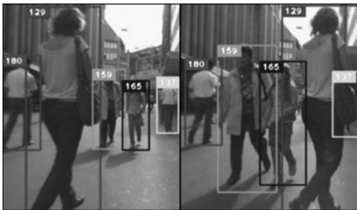
图 3-12 DeepSORT 在具有频繁遮挡的常见跟踪情况下对 MOT 挑战数据集的示例输出
