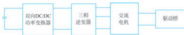
图 3-39 新能源汽车驱动系统结构图(交流电机为驱动电机)
