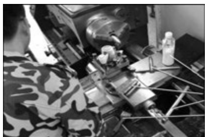
图 1.7 车床操作不规范示例
