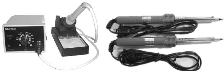
图 3.14 恒温电烙铁和普通电烙铁
